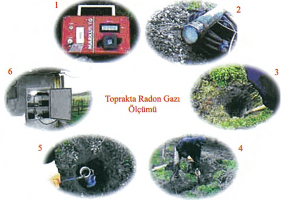
Toprakta Radon Gazı ölçümü için kullanılan aletler ve bu aletlerin kullanılmasını gösteren şekil (23)
