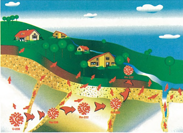
Radon gazının bozularak yeraltı suyuna ve atmosfere karışmasını gösteren şematik şekil (22)
